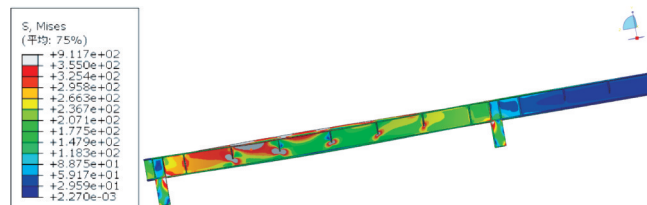
图9 单侧荷载钢栈桥应力云图(单位:MPa)
