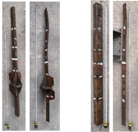
a) 对接节点主材屈曲模态 b) 未开断主材屈曲模态
