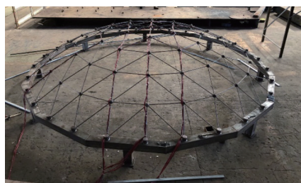
图1 K6网壳试验模型
