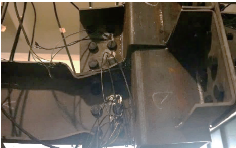
图 16 剪切试验极限破坏模式
