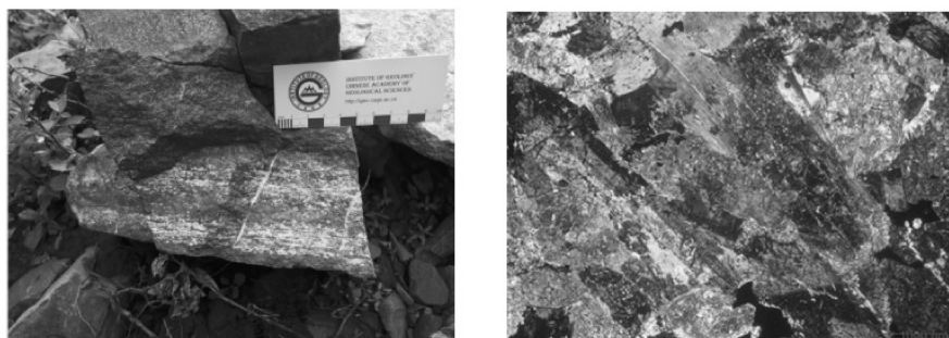
图 3 大顶子山辉长岩标本及显微照片
