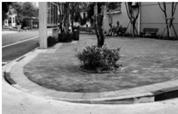
图 9 高边石下卧方式缓解高差问题
