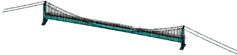
图 1 悬索桥有限元模型
