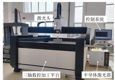
图 1 激光辐照热裂解岩石试验系统
