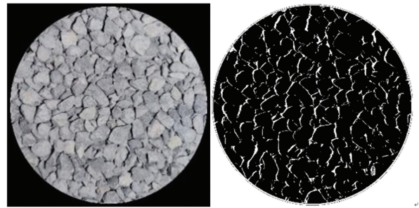
图4 碎石集料表面图像处理
