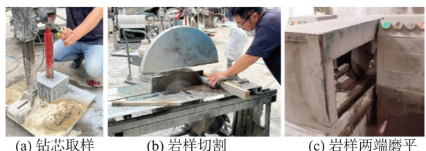
图 4 单轴压缩和巴西劈裂试验岩样制备工序
