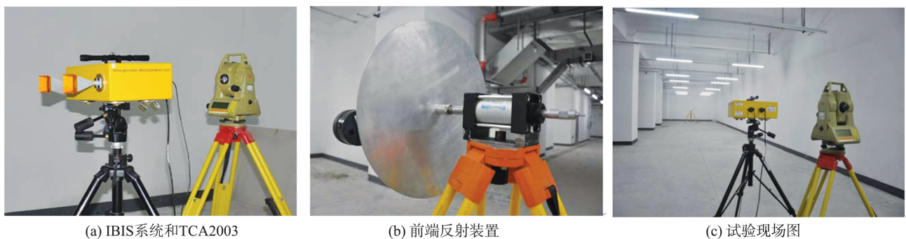
图2 IBIS 系统精度检定试验
