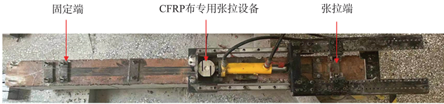
图6 碳纤维布专用张拉设备工作图
