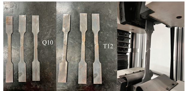
图 4 材性试验断裂图
