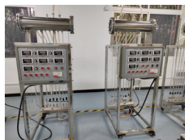
(d) 多管水循环工业锅炉实验台
