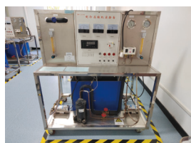
(b) 制冷压缩机性能测试平台
