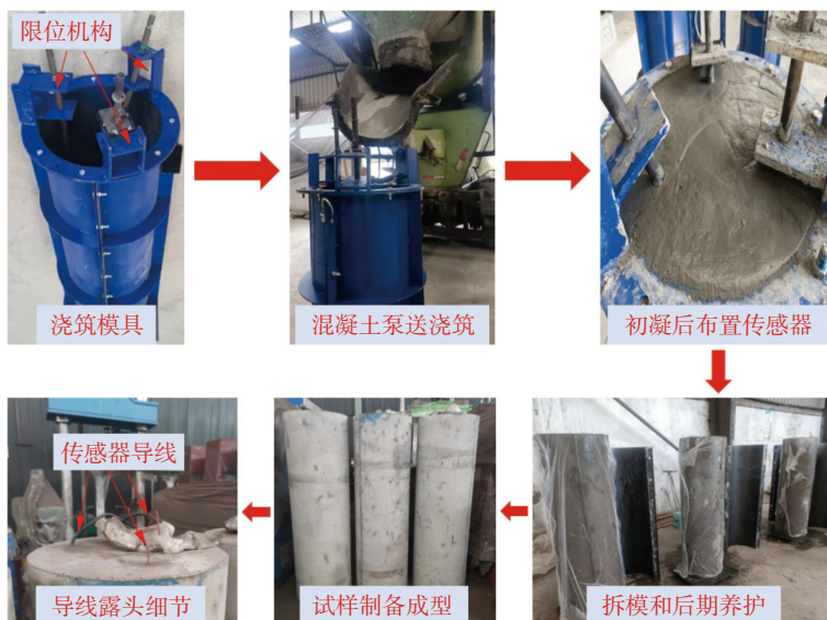
图6 试样浇筑制备
