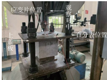
(b) 拉拔试件安装及测量
