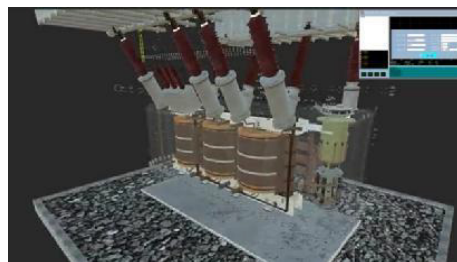
图 8 变压器绕组与变压器绕组测试仪连接图
