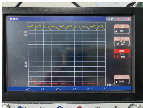
图 8 不满足低通滤波器截止角频率时恢复信号波形及频谱图
