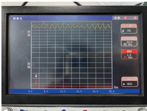
(b) 低通滤波器截止角频率为4 kHz
