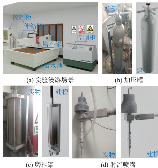
图 5 实验漫游场景及主要装置实物和建模对比图
