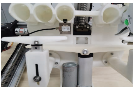
图 8 使用力传感器测量推杆推力实物图
