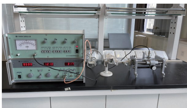
图 2 利用微波测量线测量驻波比实物图
