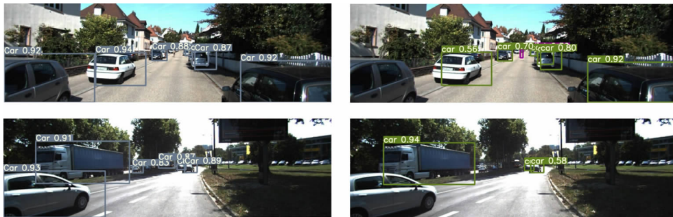
图10 改进前后YOLOv5在测试集上的对比结果(左边改进后YOLOv5,右边原始YOLOv5)
