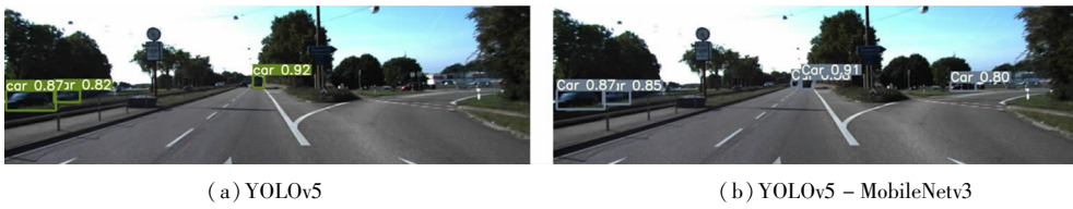
图 8 基于原 YOLOv5 和改进 YOLOv5 的道路交叉口车辆检测测试结果
