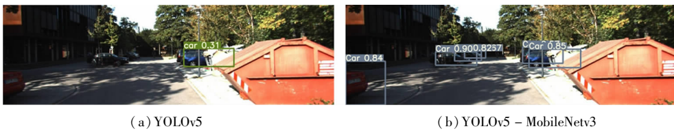
图 5 基于原始和改进的 YOLOv5 在阴影环境下的车辆检测测试结果
