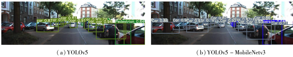
图 7 基于原始 YOLOv5 和改进 YOLOv5 的车辆遮挡检测结果
