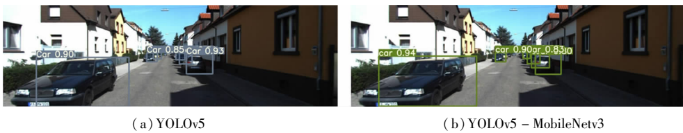
图 6 基于原 YOLOv5 和改进 YOLOv5 的多尺度目标车辆检测测试结果
