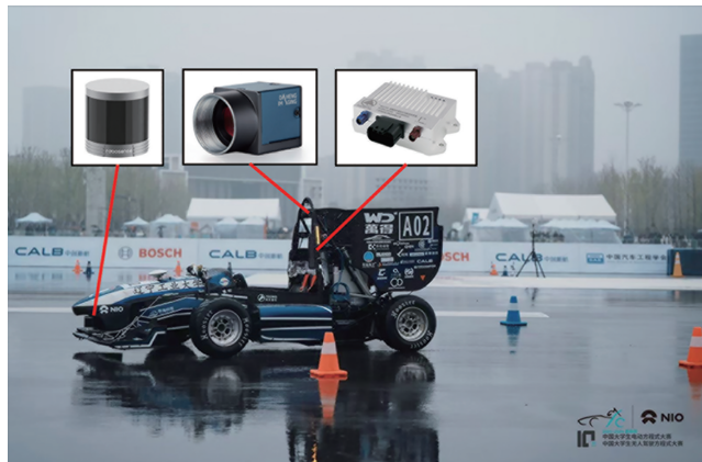
图 12 传感器与计算单元安装位置
