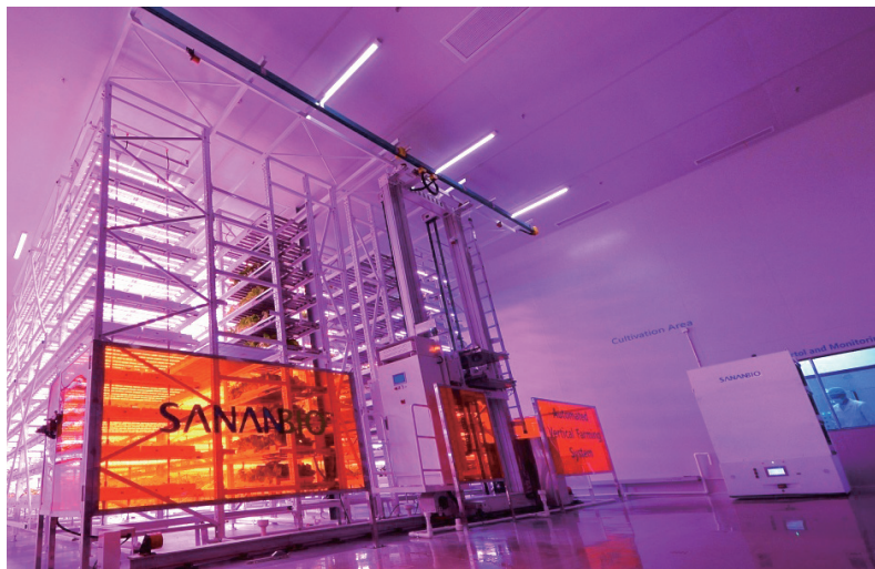
左：中试阶段的植物自动化垂直生产系统
