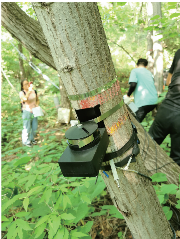
安装在糠椴树干上的2套树木径向生长测量仪
