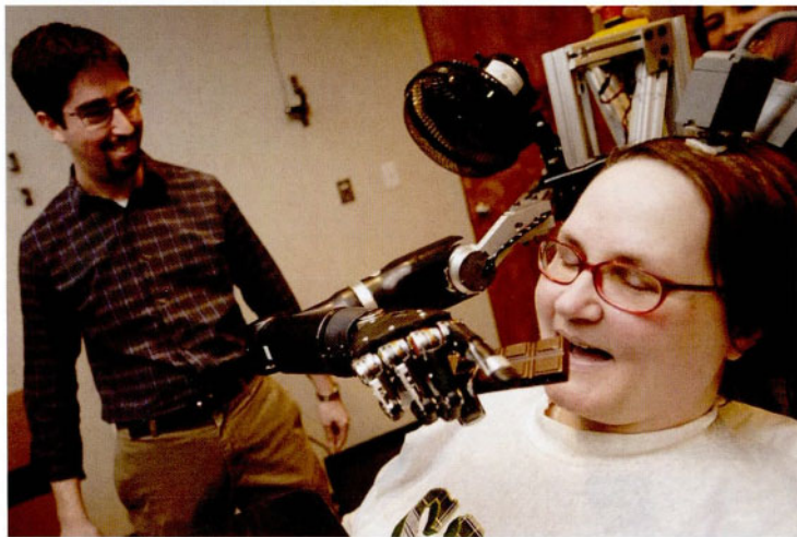
瘫痪病人简·舒尔曼能够通过脑控机械手来完成一些日常动作
