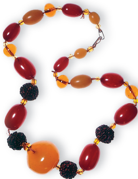
具有多枚伪造琥珀珠子的复合项链。大的黄橙色的珠子是赛璐珞，椭圆形红色珠子是酚醛树脂，椭圆形混浊的黄色珠子是酪蛋白，透明的橙色珠子和小的刻面珠子都是玻璃
