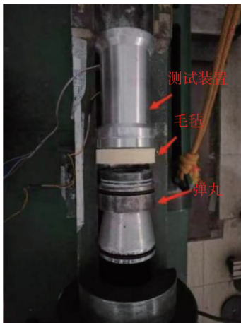
图 6 碰撞前弹丸和测试装置状态图
