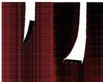
图8 着靶角度为80°时弹丸的侵彻弹道轨迹
