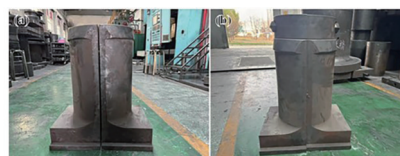
(a) 径向加载凸模 (b) 旋轮整形凸模
