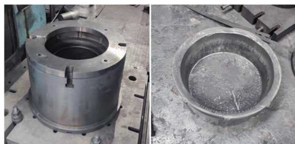
(c) 反挤压成形 (d) 最终成形坯料
