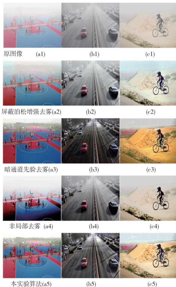
图 3 不同算法的图像去雾结果
