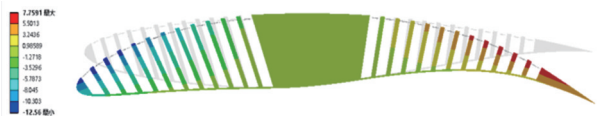
图 11 优化后的肋板水平横向位移云图 Fig. 11 Nephogram of the optimized floor horizontal lateral displacement
