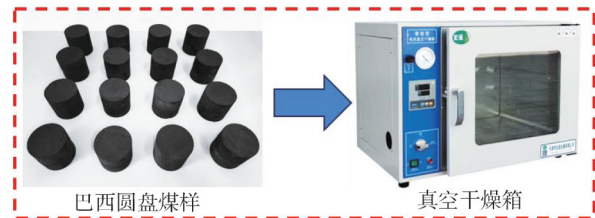
图1 部分煤样与真空干燥箱图
