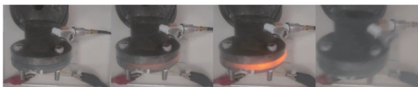
0 ms 开始点火 133 ms 引燃成功 267 ms 火光最大 500 ms 仓体震飞
