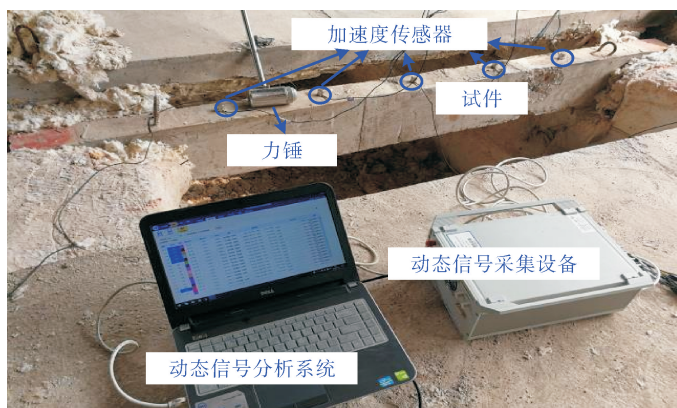
图6 振动测试现场布置
