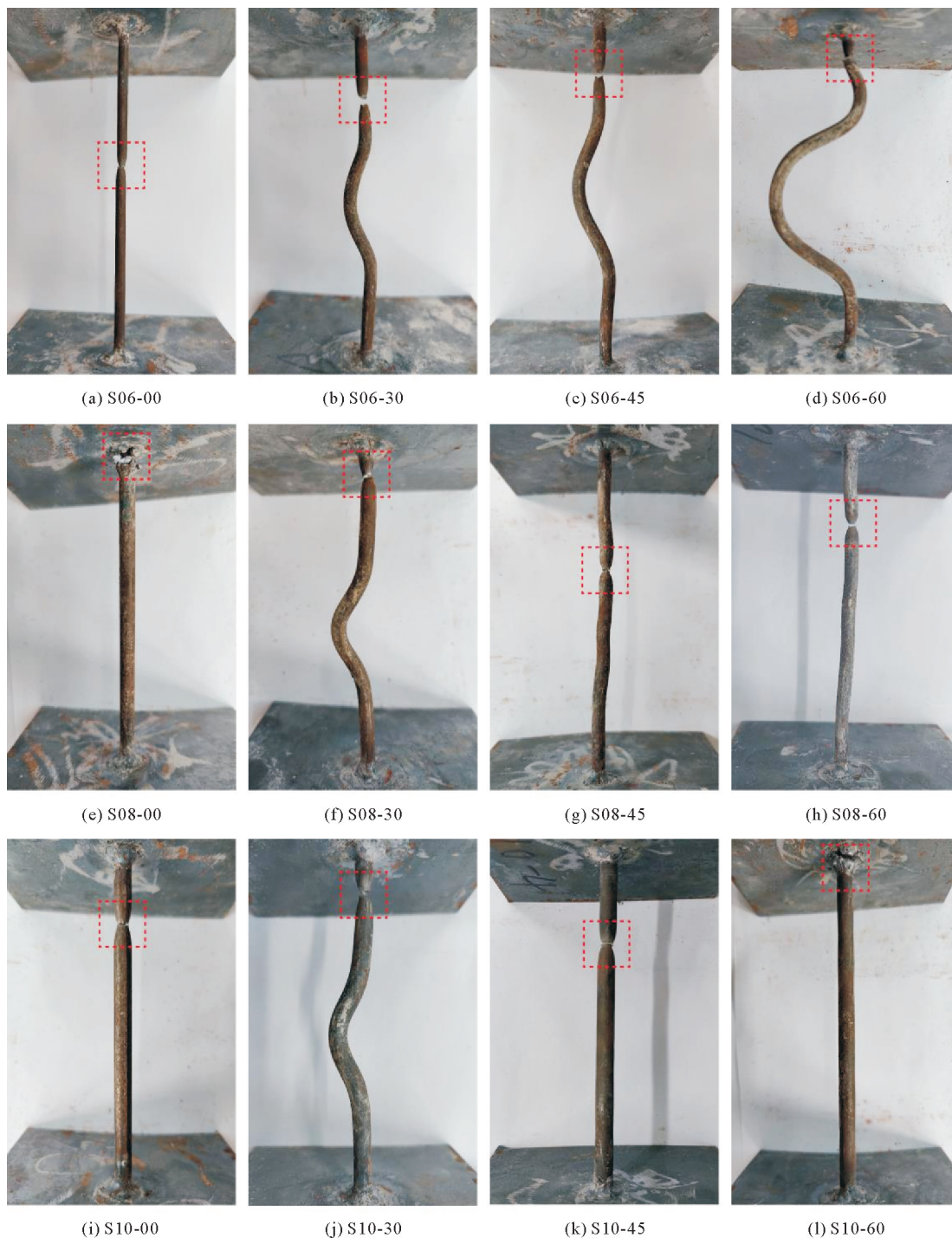
图 3 KR-SC 板单元体试件破坏
