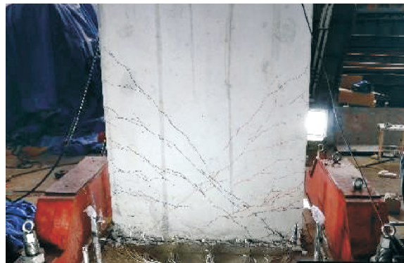
图10 试件破坏现象
