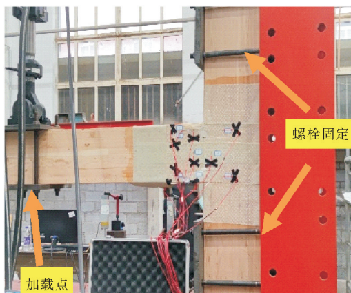
图 8 梁柱节点加载
