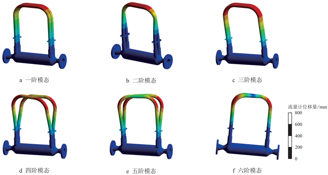
图3 流固耦合模态分析前六阶模态振型图
