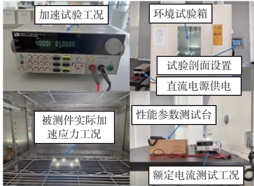
图 2 LED 芯片的加速退化试验
