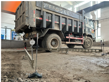
图 3 测试回弹模量试验
