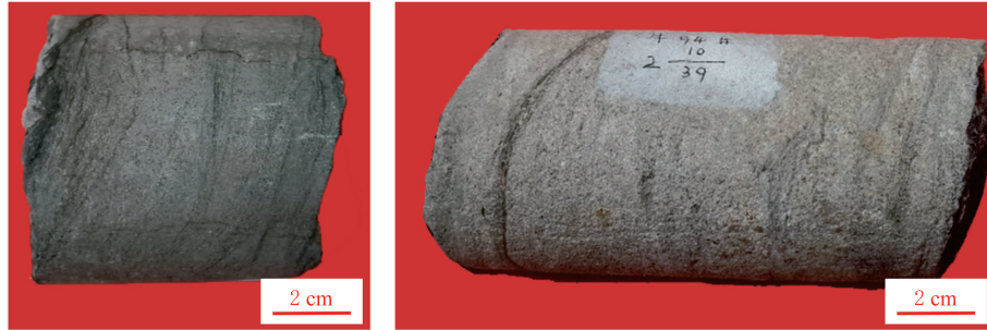
(i) 粉砂岩, NS2井, 3 683.58 m, (ii) 细砂岩, N94井, 3 909.60 m (a) 岩心照片
