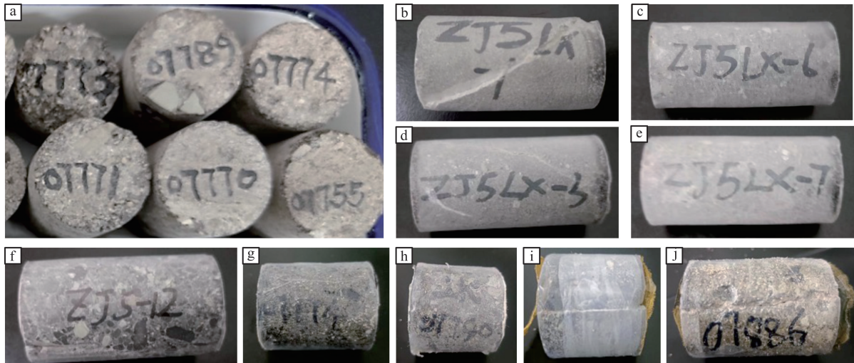
(a) 无人造裂缝岩心；(b-f) 非支撑裂缝岩心；(g-j) 支撑裂缝岩心
