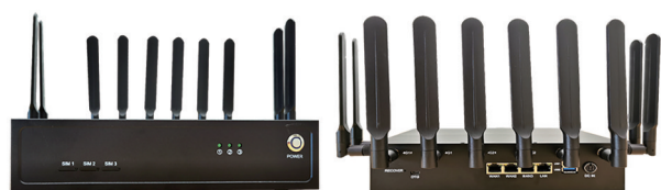
图2 多链路信息传输系统-网络聚合网关硬件正、后视图
