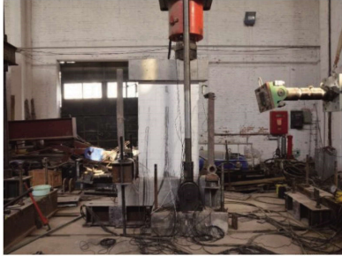
图2 试验加载装置
