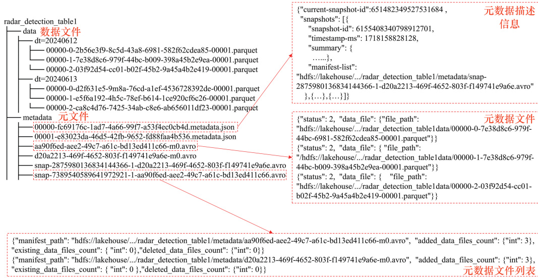
图 9 Apache Iceberg 数据存储格式 Fig. 9 Apache Iceberg data storage format
