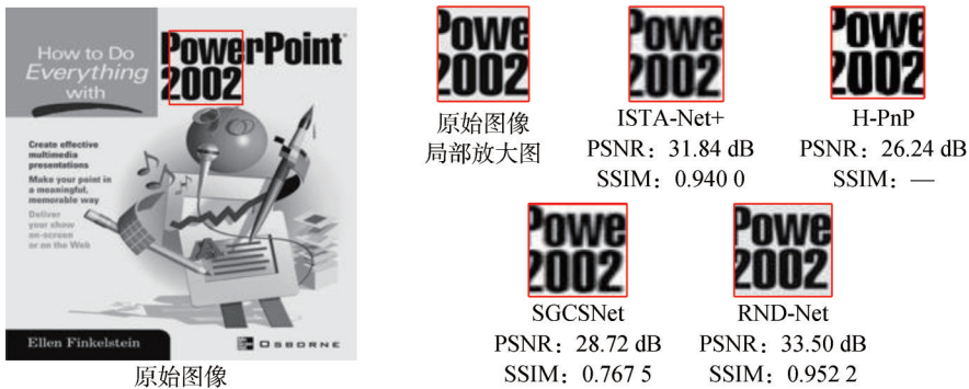
图 7 RND-Net 与 DCS 算法在“PPT3”图像(来自于 Set14)上的重建视觉效果比较
