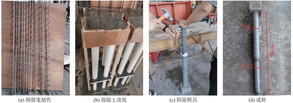
图3 模型桩制作流程 Fig. 3 Model pile fabrication process
