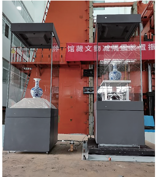
图 3 振动台试验布置
