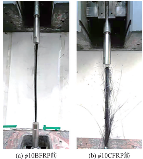
图 11 FRP 筋-不锈钢夹片锚具组装件失效模式
